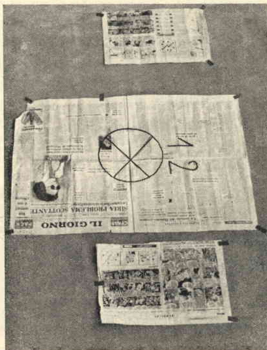
Fig. 5 - Solo per prove in profondità l'obiettivo dovrà risultare chiuso, al fine di controllare la tolleranza di messa a fuoco.
