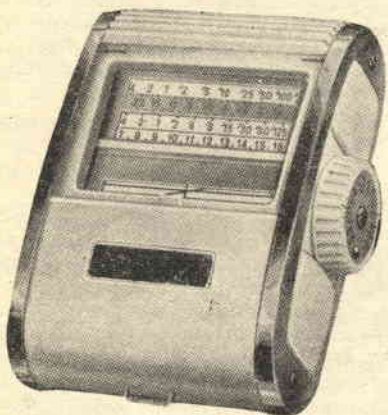
D - Esposimetro di grande precisione per luce incidente e riflessa. Prevede una tabella per controllo del COLORE della luce, utile nelle foto a colori. E' sensibile alle basse ed alte condizioni di luminosità. Da automaticamente, per collimazione dell'indice del galvanometro, i diaframmi per le varie scale dei tempi di posa e i valori luce.
