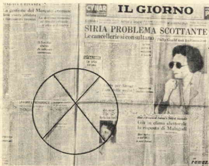
Fig. 3 - Controllando la negativa impressionata dalla macchina fotografica, si dovrà riscontrare la nitidezza dei caratteri da stampa tanto ai bordi quanto al centro.
